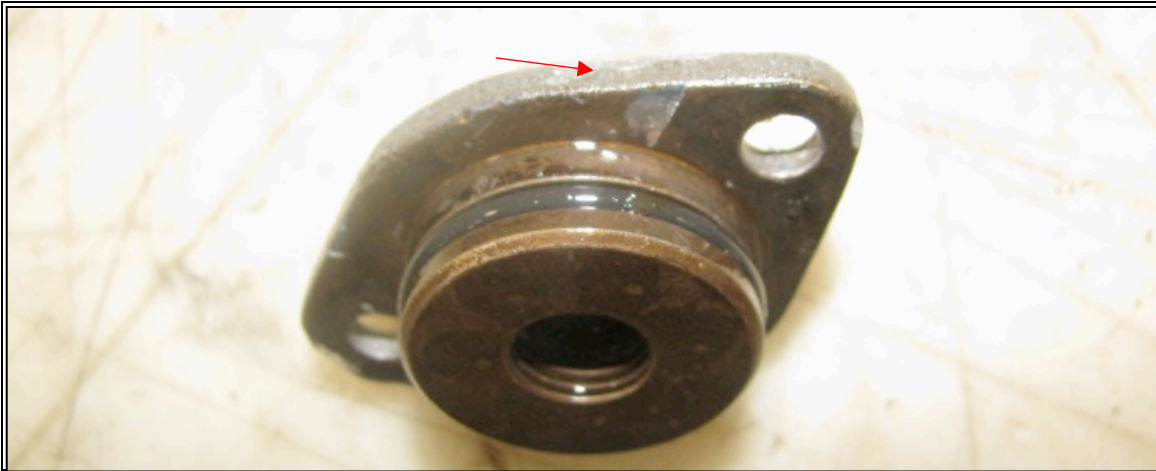
Fotografía No. 5: marcas por uso de herramienta no apropiada
