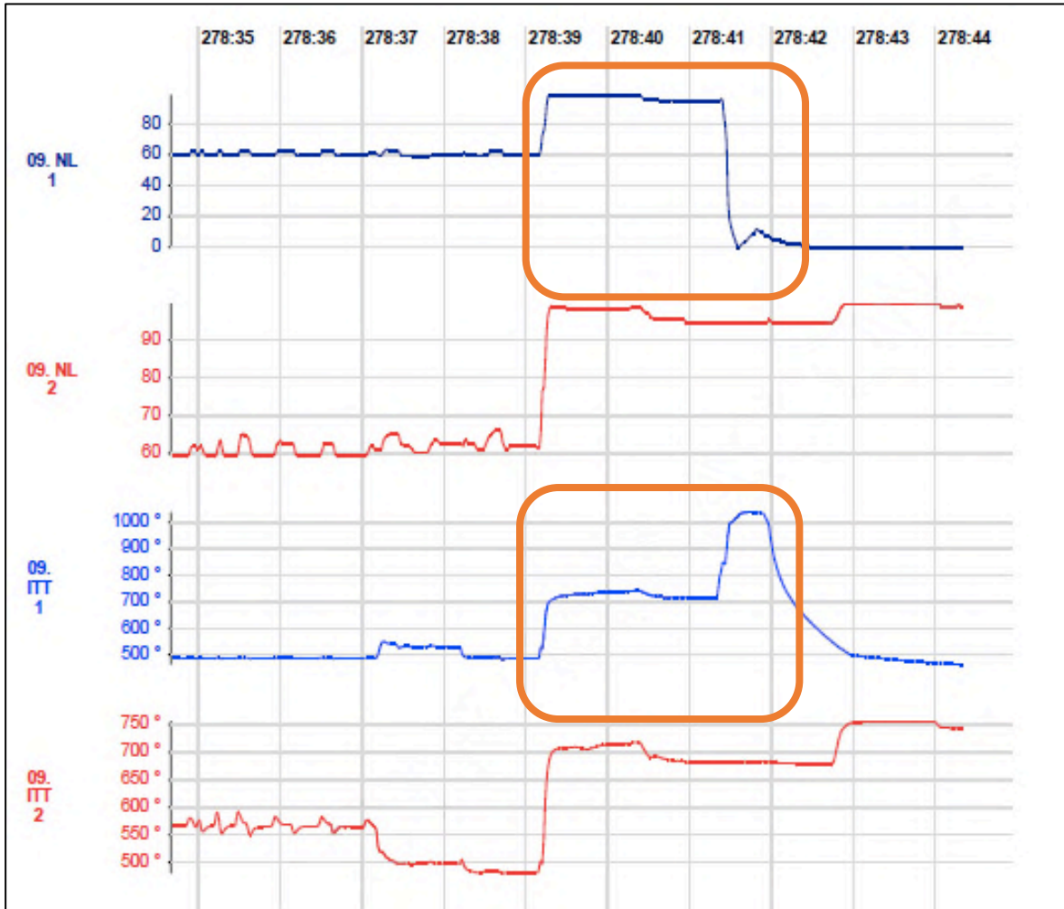
Gráfica No. 3: parámetros de los dos motores, antes y durante la falla
